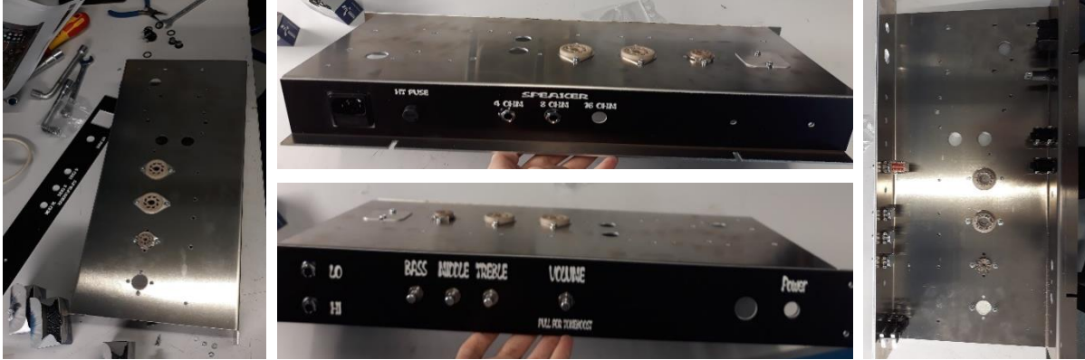
8- Assemblage du châssis (1)
