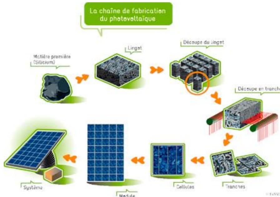
Figure 17 : Chaîne de fabrication du photovoltaïque
