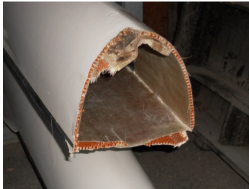
Illustration 1: Vue en coupe d'un aviron endommagé montrant la structure composite
