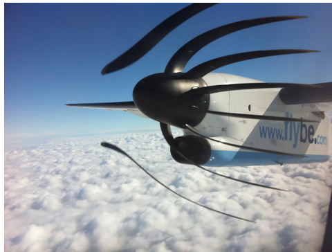
FIGURE 17: Effet rolling shutter avec un objet en rotation : une hélice d'avion
