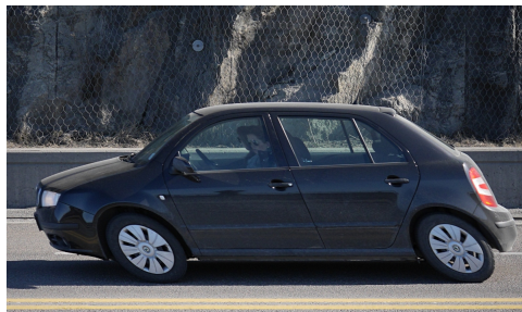
FIGURE 18: Effet rolling shutter avec un objet en translation
