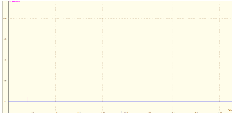
FIGURE 4: Test 1 : Le spectre du signal mal échantillonné, Amplitude (F) en fonction de la fréquence (Hz)
