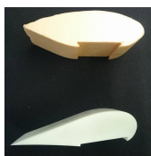
FIGURE 2.22 – au dessus profil symétrique et en dessous celui fait avec imprimante 3D
