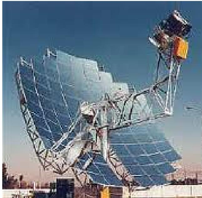
FIGURE 3.2: Capteur parabolique "Dish-stirling" à Phoenix, Arizona
