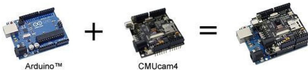
figure 3: La compatibilité de la carte Arduino et de la CMUcam4
