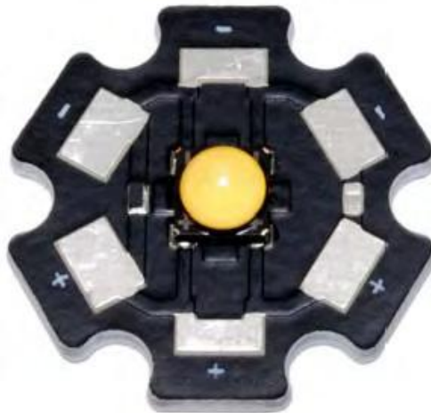
High Luminous Efficacy Blue LED Emitter (cf. Annexe Fiche technique de la diode utilisée)
