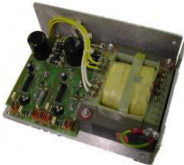
figure 3 : Alimentation de puissance R3 power 5V 6.0A
