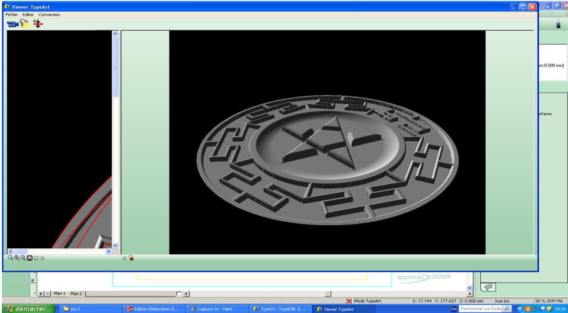
La conception de la pièce terminée, nous avons donc pu procéder à la préparation à l'usinage, grâce au dernier module de Type 3, le module CAM.
