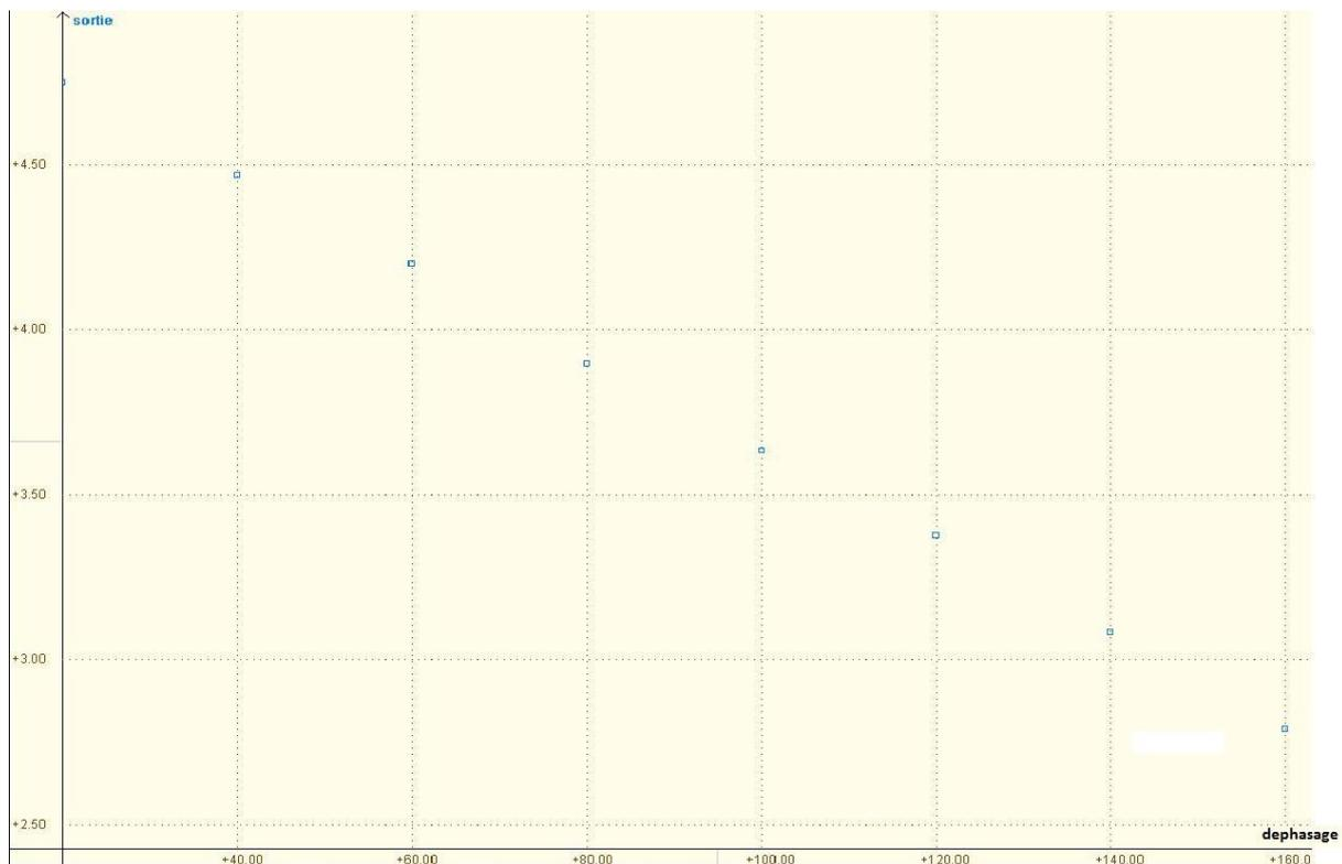
Figure 3-4 Courbe de la tension en fonction du déphasage
