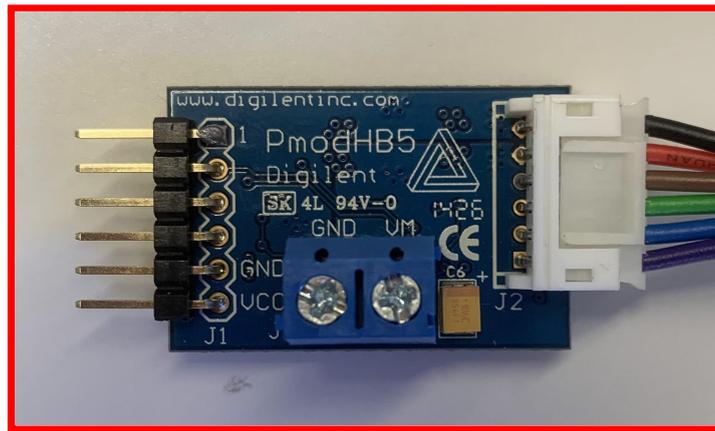
Figure n°14 : Photo de la carte contrôleur moteur PmodHB5
