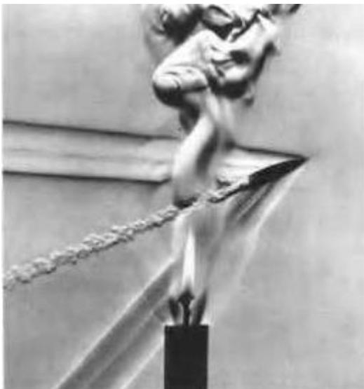
*Figure 8 : Balle traversant à grande vitesse la flamme d'une bougie*
