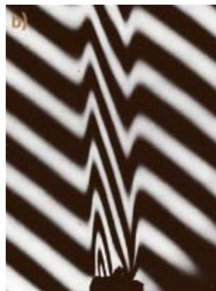
Figure 25 : Panache convectif au-dessus d'une bougie visualisé par un interféromètre différentielle à prisme de Wollaston (Tropea et al. (2006))
