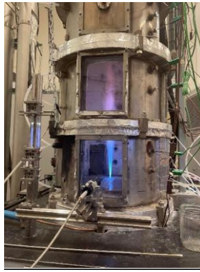
Figure 8 : Flamme 100% méthane Figure 9 : Flamme 100% hydrogène
