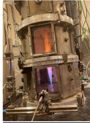
Figure 8 : Flamme 100% méthane Figure 9 : Flamme 100% hydrogène
