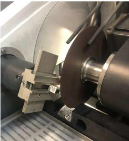
L'échantillon d'Hastelloy X imprimé à l'horizontal a été coupé en réglant la micro-tronçonneuse de façon à ce qu'elle fasse deux découpes consécutives. Elle a également été programmée pour que les nouveaux échantillons aient une épaisseur d'environ 3 mm.
