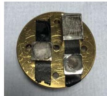
figure 10 : échantillons sur le support du MEB
