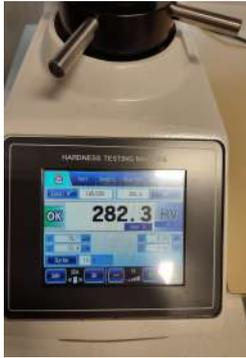
L'essai de dureté Vickers convient à tous les matériaux solides y compris métalliques. Un essai de dureté permet de connaître les propriétés d'un matériau telles que sa résistance, sa résistance à l'usure, sa ductilité ainsi qu'à déterminer si le traitement de ce matériau convient à l'usage souhaité.
