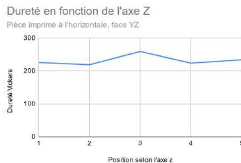
Ces deux graphiques montrent la dureté des pièces imprimées verticalement et horizontalement suivant la direction d'impression z. Les moyennes de dureté sur 5 mesures sont HV=248 pour la verticale, et HV=232 pour l'horizontale.
