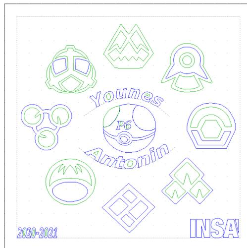
Pour réaliser le tracé de notre plaque nous avons utilisé le logiciel Type3, plus précisément, la partie "type Edit" dans laquelle nous nous sommes servi des différents outils tel que le mode point ou bien encore le mode texte qui nous a permis d'écrire nos prénoms, P6 et l'année.
