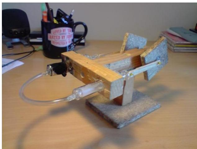
**Figure 7: Moteur de type alpha**
