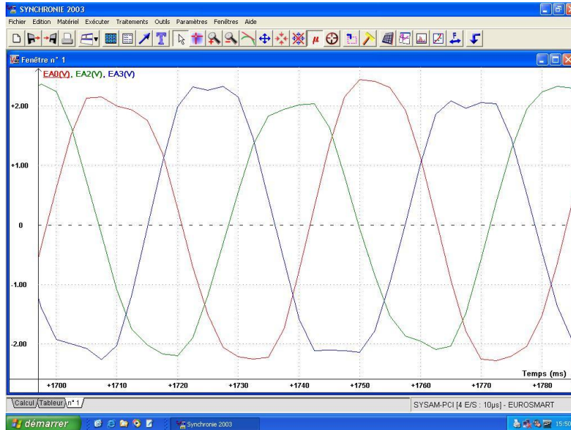
Figure 20 : Mesure de la tension aux bornes des 3 couples de bobines (branchement étoile)
