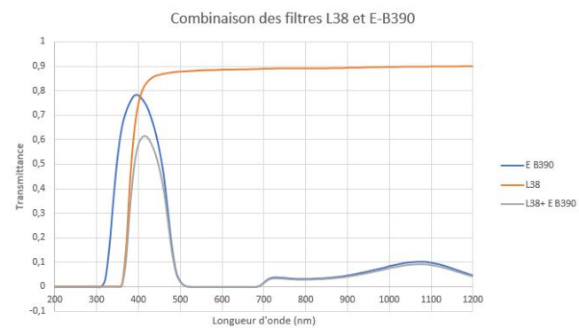
FIGURE 3.28 – Courbe d'addition des transmittances des filtres L38 et E-B390 [30, 31]
