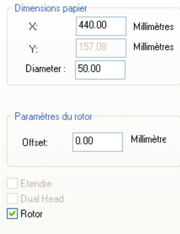
**En cochant Rotor:** la dimension de la feuille est modifiée, le Y est désactivé et il faut saisir la valeur du diamètre de l'objet à l'endroit qui va être gravé. La hauteur Y sera donc le diamètre x Pi
