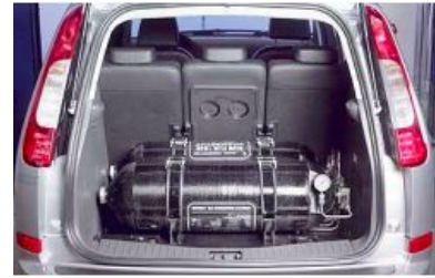
Illustration n°14- Voiture équipée de réservoirs
