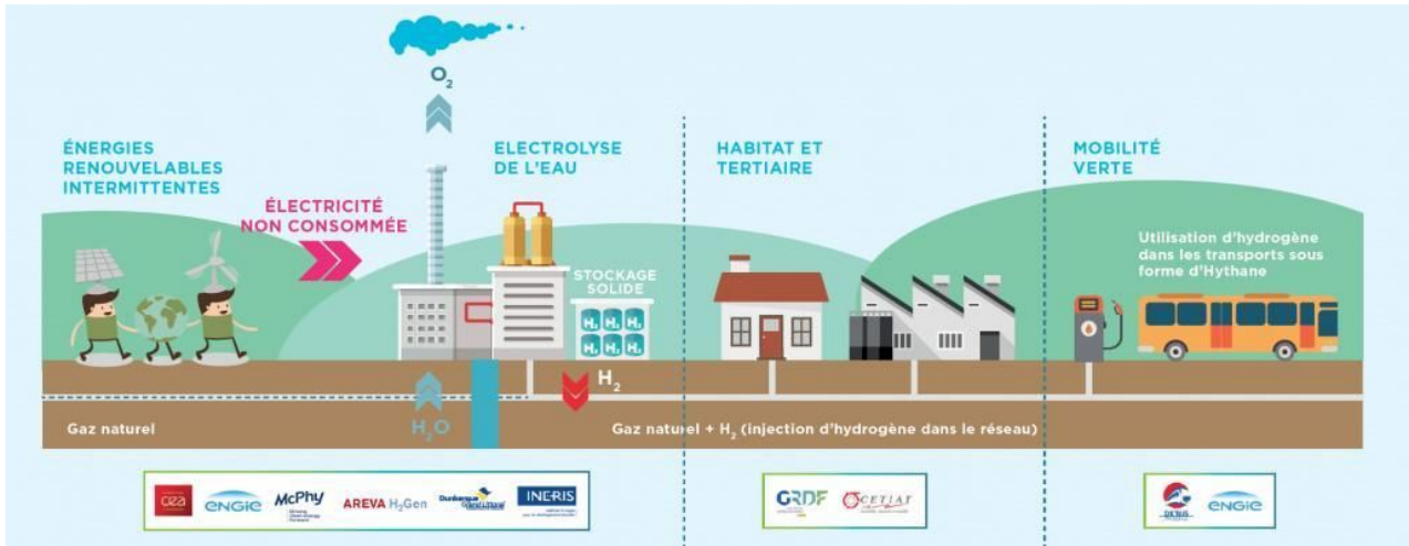
Illustration n°22- Schéma du principe du projet GRHYD
