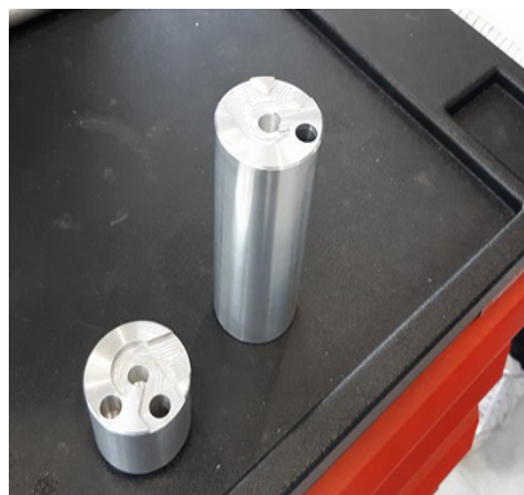
Support pattes de dérailleur (Modélisation puis réel)
