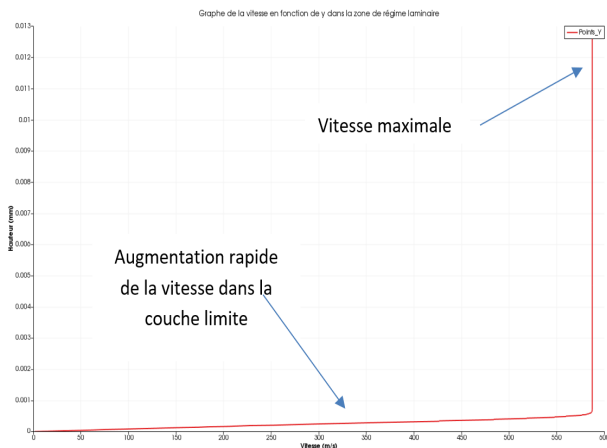
FIGURE 2.5 – Graphe de y en fonction de la vitesse dans la zone de régime laminaire
