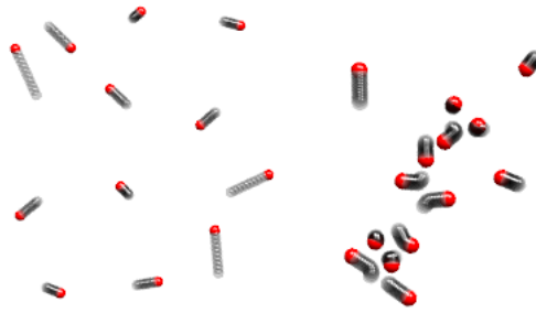
FIGURE 3.3 – À gauche : un gaz type Parfait et à droite, un gaz type Réel
