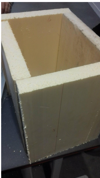
FIGURE 2.7 – Assemblage des plaques avec de la colle
