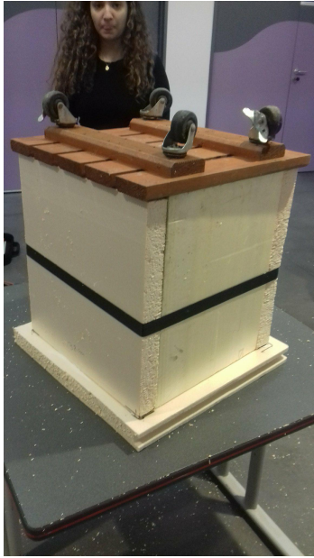
FIGURE 2.9 – Maintiens à l'aide du support à roulettes afin de coller la base
