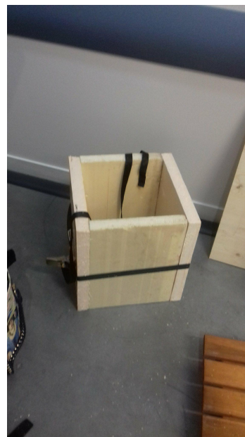
FIGURE 2.8 – Maintien à l'aide de sangles le temps que la colle sèche
