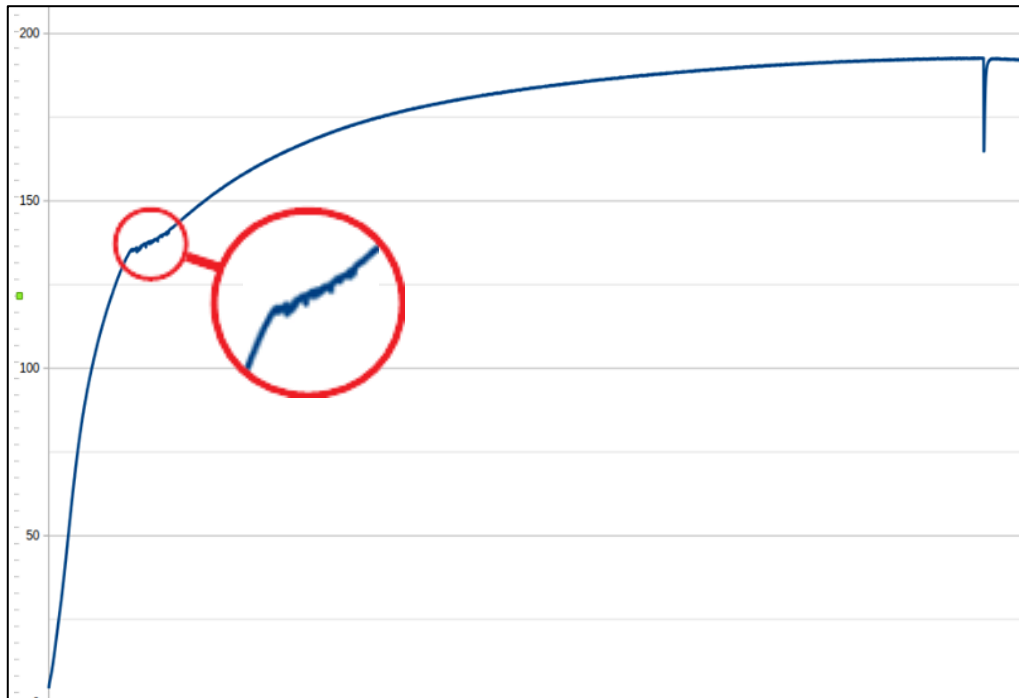
Courbe de traction d'un échantillon du matériau étiré par une filière
