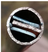
Mise en place avant laminage
