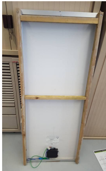
Structure en bois fixée au panneau
