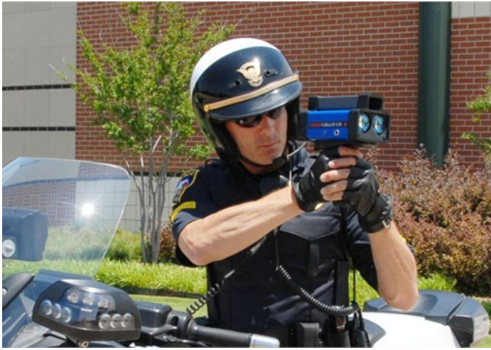
FIGURE 1.4.2 – Exemple d'utilisation d'un LiDAR pour mesurer la vitesse
