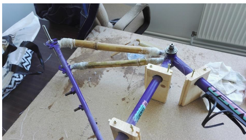
Figure 18 : Début de l'assemblage des tiges de bambou
