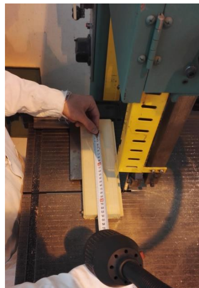
Figure 11 : Découpage des planchettes
