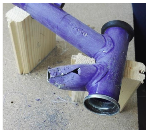
Figure 16 : ...pour ensuite être compressée (réduction du diamètre)
