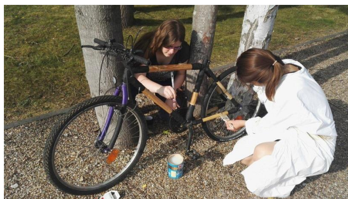
Figure 20 : Lasure et pose de ruban adhésif
