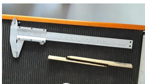
Figure 5 : Lamelle fissurée après l'essai
