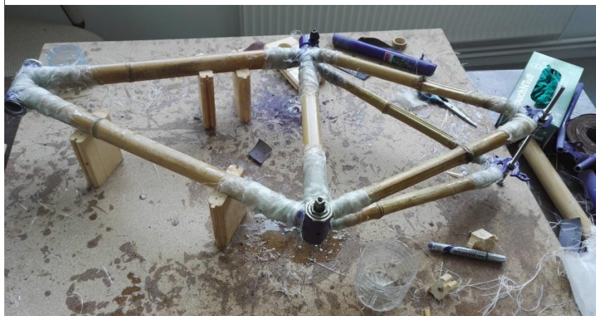
Figure 19 : Cadre final en bambou et fibre de verre
