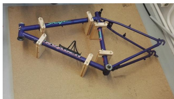
Figure 12 : Socle final accueillant de vélo
