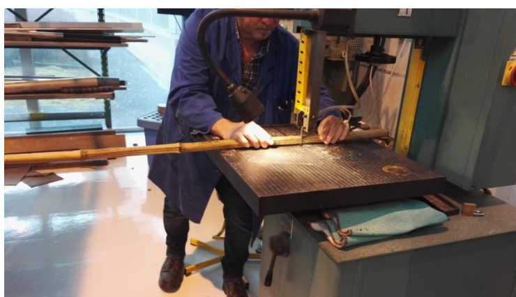
Figure 14 : Découpage d'une tige dans l'atelier de mécanique
