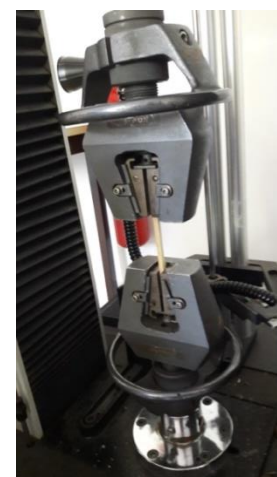
Figure 4 : Essai de traction sur une lamelle de bambou
