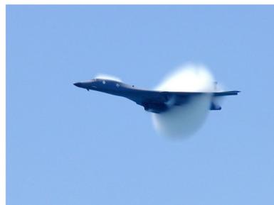
Quand l'avion a franchi le mur du son, les ondes de choc accumulées au niveau du nez de l'appareil se libèrent et forme un cône de mach. Ce cône est l'unique zone où l'on peut entendre le "bang". C'est pour cette raison que le pilote n'entend pas le 'bang' car il est situé à l'intérieur du cône. En fonction de la vitesse de l'avion, ce cône prend une forme différente : plus l'avion vole rapidement et plus le cône est étroit. Son angle peut être
