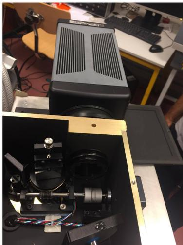
FIGURE 5 – Vue du dessus du spectroscope Action SpectraPro SP-2150 et Caméra PI-MAX4
