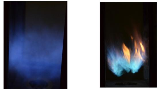
*Image 14 : Photo du spray en marche et allumé respectivement sous confinement et sans confinement*
