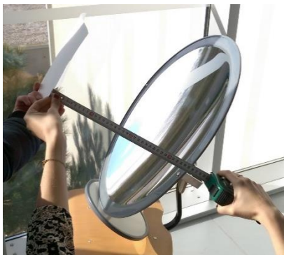
Mesure de la distance focale
