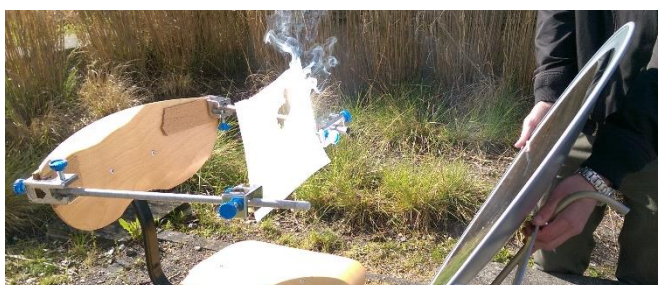
Dispositif de maintien de la feuille, en combustion
