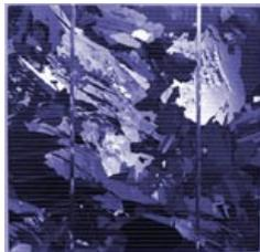
Si le silicium refroidi en formant plusieurs cristaux, il s'agit alors de **cellules en silicium polycristallin**. Le panneau est alors bleu foncé non uniforme. Le rendement est un peu plus faible que celui de panneaux photovoltaïques en silicium monocristallin (11% à 15%), mais est moins cher à fabriquer et représente ainsi le meilleur rapport qualité-prix.
