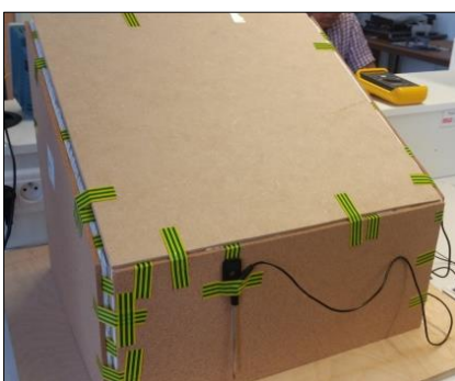
La maquette, avec le second toit, et du polystyrène PUIS du liège autour des parois
