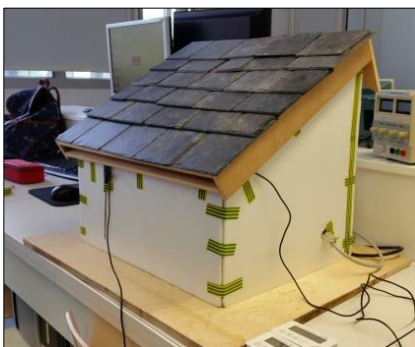
La maquette, avec le même toit, et du polystyrène posé tout autour des parois
