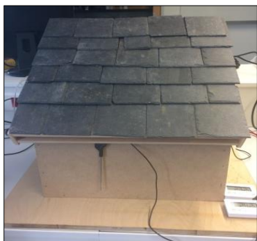
La maquette nue, avec le premier toit (recouvert de tuiles avec une doublure remplie de laine)
