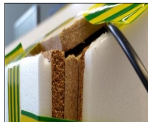
Pont thermique dû au passage du fil du thermocouple situé à l'intérieur de la maquette
