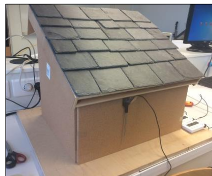
La maquette, avec le premier toit, et du liège posé tout autour des parois
