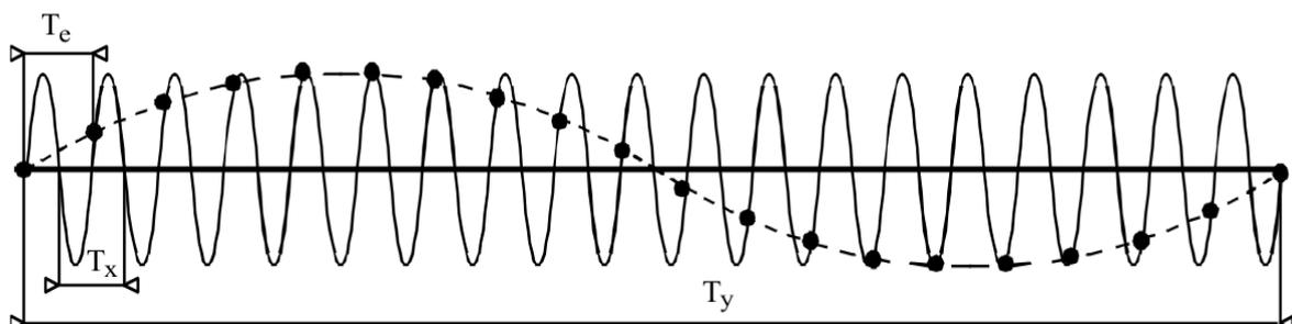
On observe qu'avec une période d'échantillonnage  $T_e$  trop grande, le signal après le CAN (ici celui en pointillé) ne correspond pas du tout à celui en entrée. En effet, le signal de sortie possède une fréquence plus petite : c'est ce qu'on appelle le phénomène de repliement du spectre.
