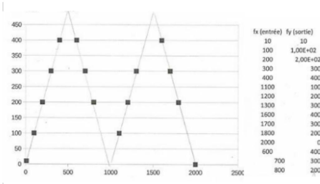
On constate bien que la fréquence de sortie n'est pas identique à celle du signal d'entrée lorsque la fréquence de celui-ci est trop élevée.
