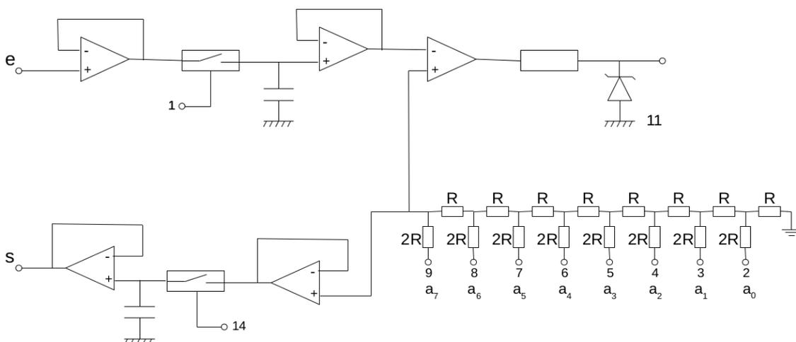
Le montage est composé de 5 amplificateurs, 2 interrupteurs, 2 condensateurs et 8 résistances.
