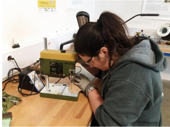
Réalisation des trous dans le châssis
