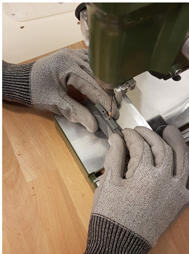
Reperçage d'une pièce
