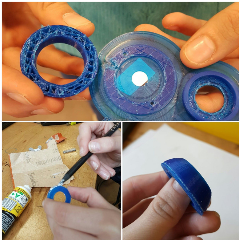
Défaut d'impression sur une pièce et recollage de celle-ci
