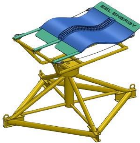
Fig 8 : Projet de membrane ondulante EEL Energy
