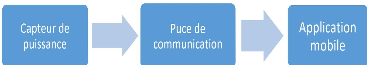
Le capteur est sensible grâce à l'étude mécanique à la puissance fournie par l'utilisateur, il envoie des données sérielles à la puce qui est programmée pour analyser le signal du capteur et envoyer ces données à l'application mobile qui affiche la valeur de puissance.
