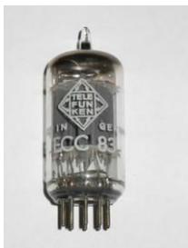
Ici, l'ECC83 est composée de deux triodes qui peuvent fonctionner de façon indépendantes, elles ont un fort gain en tension. Elle est plutôt indiquée pour préamplifier des faibles signaux.
