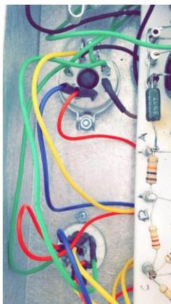
La deuxième partie du montage de notre châssis consiste, elle, à monter la turret board dans celui-ci.
