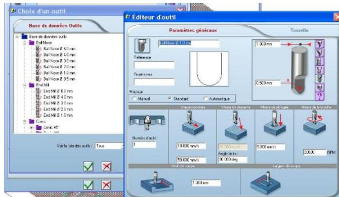
Ensuite, nous avons paramétré l'usinage en trois temps : demie finition (usinage grossier), finition (usinage précis) et pour terminer, la simulation afin d'avoir un aperçu fidèle au rendu final que l'on obtiendra. L'usinage s'effectue en balayant la surface selon un angle de 45°.
