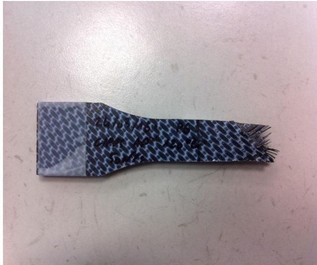
Photo annexe 1 : Éprouvette matériau composite fibres 45/45 après rupture
