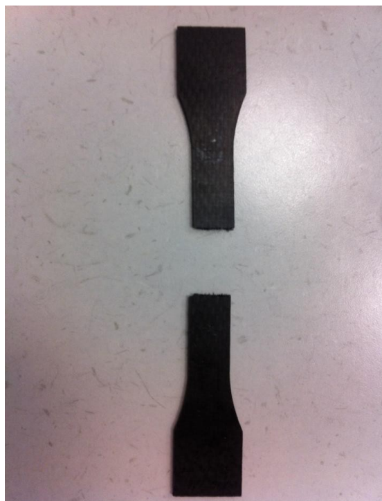
Photo annexe 2 : Éprouvette matériau composite fibres 0/90 après rupture
