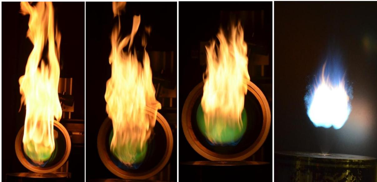
*figure 15 : Résultats obtenus en diminuant progressivement le débit d'air*
