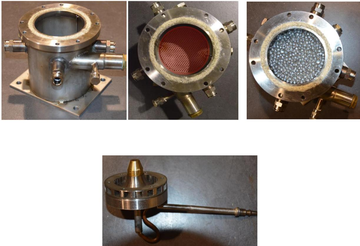
figure 12 : Brûleur démonté et injecteur
