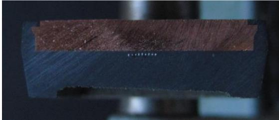
Figure 3 : Transistor en coupe
