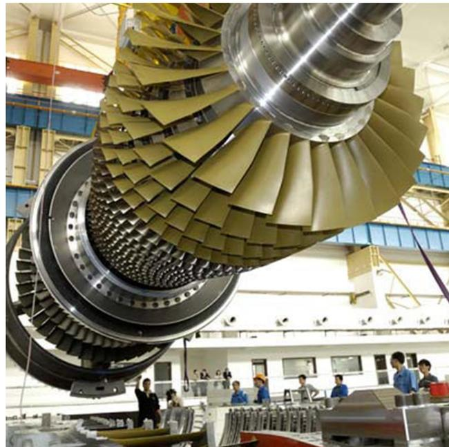
*Figure 4 : Photo d'un réacteur dont certaines parties sont composées d'un superalliage*
