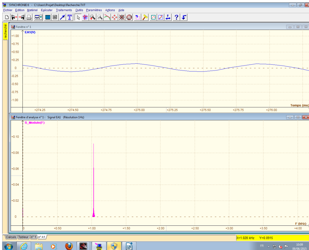
FIGURE 2.15 – Signal dont l'amplitude est recherchée avec en bas sa fréquence et son amplitude mesurée par une analyse de FOURIER réalisée par Synchronie.
