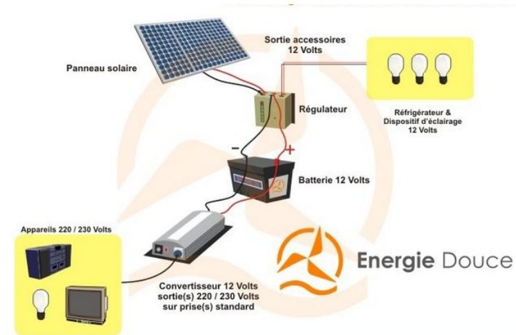
Schéma 1: Montage de raccordement d'un panneau photovoltaïque.
