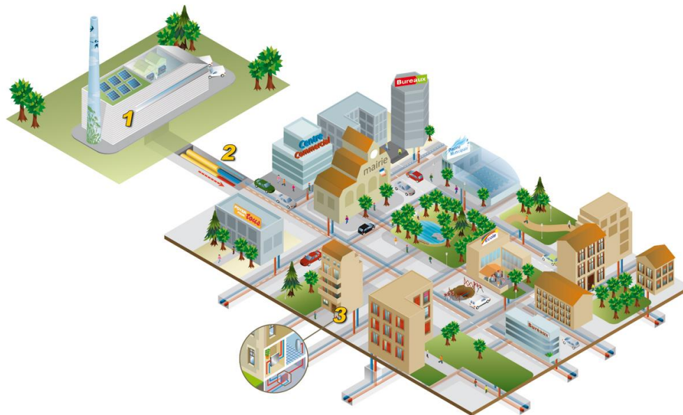
1 : Chaufferie Maromme ; 2 : Canalisations ; 3 : Sous-station
