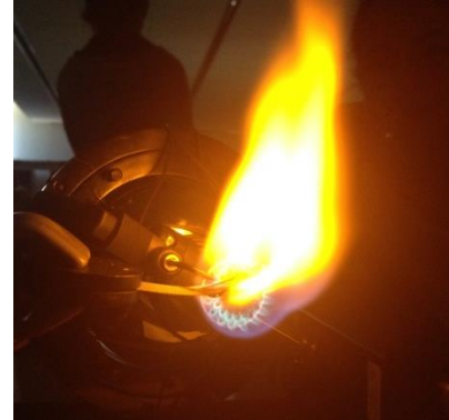
Figure 23 : Photographie de la flamme en présence de nitrate de sodium
