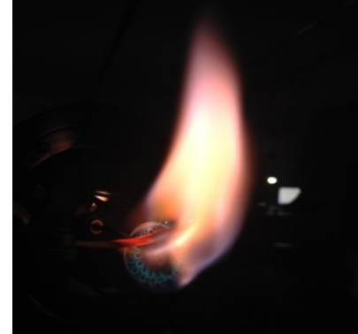
Figure 20 : Photographie de la flamme en présence de nitrate de potassium
