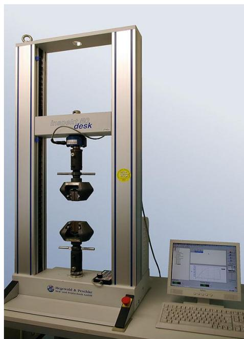
*Machine à essais de traction*
